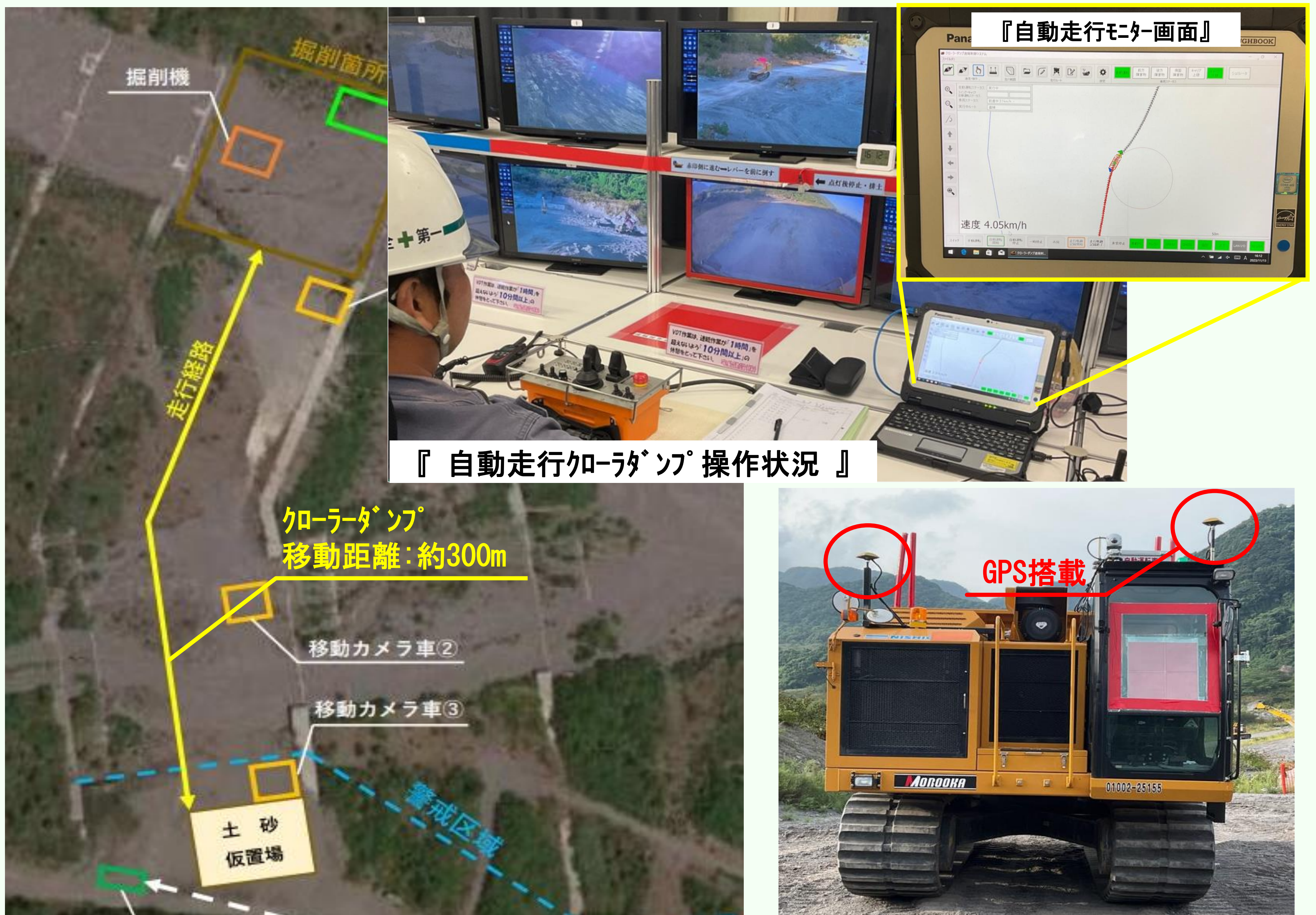
『 自動走行クローラダンプ 走行経路図 』
