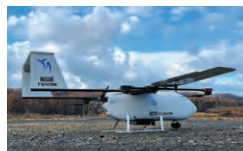
《特別企画展示》 北海道大学広域複合災害研究センター／VTOL固定翼UAVによる有珠山監視・計測の巡回飛行映像と実機（LiDAR装着）展示
